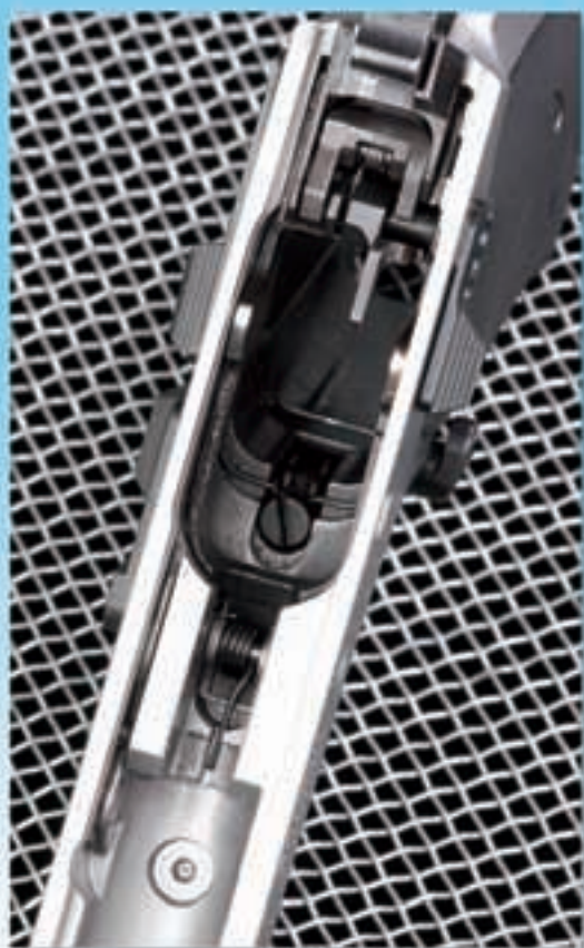
Blick ins Innenleben. Die Schraube am unteren Bildrand fixiert den Abzugsbügel, die beiden hinteren Schrauben sind vom Schloss verdeckt.
