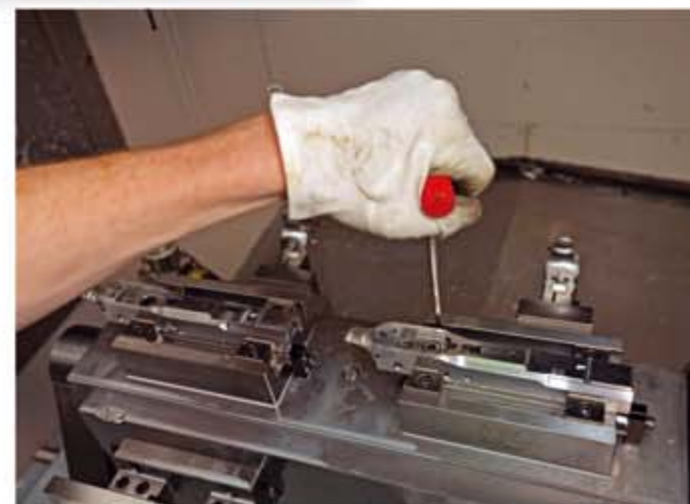
Die Handarbeit bei der CNC-Fertigung beschränkt sich weitgehend auf das Einspannen der zu bearbeitenden Stücke. Einmal programmiert, läuft der Prozess automatisch ab.
