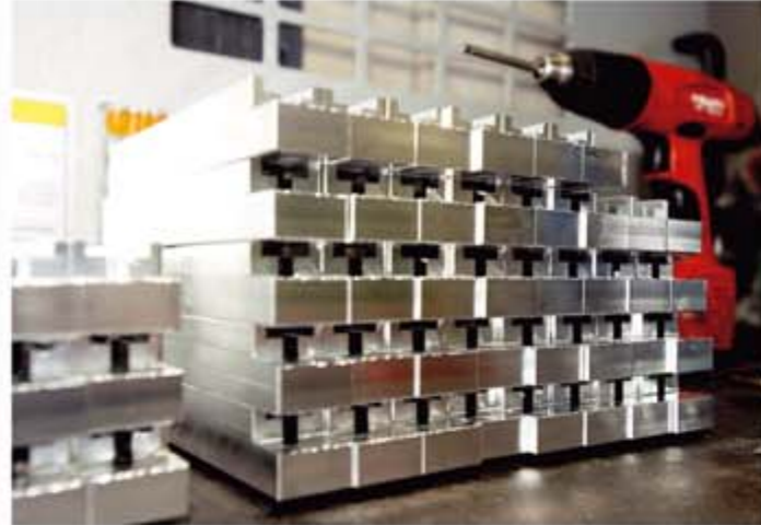
Rohteile aus Stahl und Alu warten hier auf ihre weitere Bearbeitung in einer der drei CNC-Maschinen.
