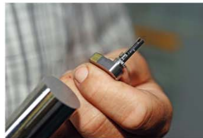
Was früher aus Feinguss von Zulieferbetrieben hergestellt wurde, wird heute auf eigenen Maschinen aus dem Vollen gefräst, wie auf diesen Bildern halbfertige Sicherungshebel für die 3000er Serie.
