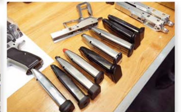
Ein HiCap-Griffstück mit Magazinen diverser Anbieter. Idealerweise sollten alle mit den Sphinx-Pistolen störungsfrei funktionieren.
