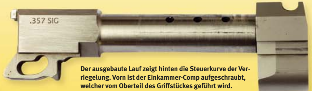
Die spürbare Rückstoss- und Hochschlagdämpfung der starken Patrone ergibt sich aus der Prallfläche im aufgesetzten Comp sowie den zwei mal drei Bohrungen im Hybrid-Lauf.
